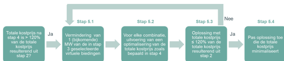
Figuur 6 – proces in de situatie waarin de totale kostprijs van de aFRR-capaciteitsveiling na stap 4 hoger zijn dan 120% van de totale kostprijs resulterend uit stap 2 (in de veronderstelling dat de TDC Factor 120% is)
